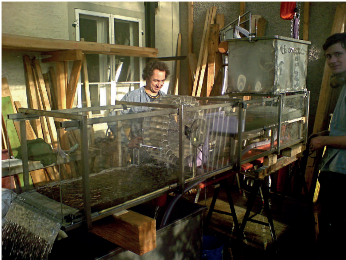
modellkanal mit herzogenmühle-wasserrad, masstab 1:10
