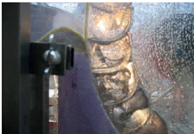
detail einlauf mittelschlächtiges wasserrad
